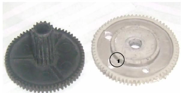
Los dos interruptores son accionados por el tornillo colocado en el piñón, como limite de carrera (1) y a su vez accionan la inversión de giro del motor, generando el movimiento que produce el desplazamiento del robot.
